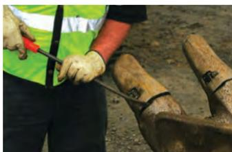
**Passaggio 4:** in alcune applicazioni, le particelle accumulate potrebbero impedire la rimozione della punta. Usare il palanchino sul retro della punta per liberarla dalle particelle.
