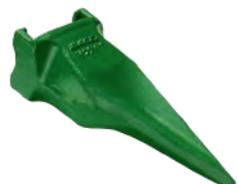
**VY (VYH)** - La VY è una capsula con forma a V, nervatura a Y non simmetrica, utilizzata quando è necessaria la massima penetrazione come in terreno gelato o argillite. Ha una maggiore durata all'usura rispetto a punte di altre forme e mantiene più a lungo l'affilatura. La VYH è la versione più robusta della VY.
