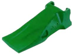
**TYL** - La TYL è una capsula two-way (doppio modo), con nervatura a Y, e punta lunga. È utilizzata per un attacco al terreno livellato (senza solchi) per impieghi normali; la parte superiore può essere girata verso il basso per uno scavo più energico. La forma asimmetrica è ideale per la sostituzione della capsula lunga CAT.
