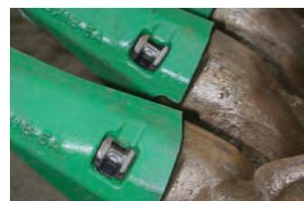
**Passaggio 9:** in posizione completamente chiusa, la superficie della serratura risulterà incavata rispetto alla superficie della punta.
