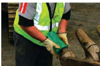
**Passaggio 7:** installare la nuova punta sul nasello. Assicurarsi che il meccanismo di blocco sia aperto prima di procedere all'installazione.
