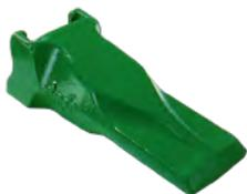
**SYL** - SYL significa capsula standard con nervatura a Y lunga, ed è la proposta standard per benne di escavatori. Il suo design simmetrico permette di mantenere un profilo costantemente affilato per una buona penetrazione, è dotato di una nervatura a Y che conferisce robustezza e abbondante metallo d'usura. È una scelta eccellente per impieghi generali.
