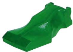
**ARH** - La ARH è una capsula progettata specificatamente per applicazioni Abrasive quali la movimentazione di scorie calde (Hot Slag). La ARH dispone di un massiccio zoccolo, orecchie più spesse e una sezione della cavità di grosso spessore per resistere saldamente sul nasello nelle applicazioni più pesanti. Può essere utilizzata in applicazioni diverse dalla movimentazione di scorie calde dove è necessaria una quantità maggiore di metallo d'usura.
