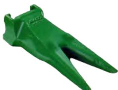
**TVY (TVYH)** - La TVY è una capsula Twin (gemella), con forma a V, nervatura a Y asimmetrica con eccellente capacità di penetrazione. È concepita per essere usata in posizione angolare quando si montano le capsule VY al fine di aumentare la lunghezza di scavo rispetto ai fianchi della benna. La TVYH è la versione più robusta.
