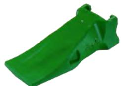
**TYLCE** - CE indica una capsula Continuous Edge. La cavità della capsula non ha forma elicoidale, in modo da poter essere montata senza essere ruotata sul nasello e per poter essere applicata assieme ad una lama saldata alla stessa ed avere una benna continuous edge per pulizia piazzale, livellamento terreno, scavo con taglio uniforme.
