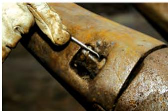
**Passaggio 1:** pulire la cavità del meccanismo di blocco da eventuali particelle di materiale nella sezione superiore e inferiore del meccanismo.
