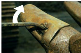
**Passaggio 2:** inserire il palanchino nel lato superiore del meccanismo di blocco e ruotarlo verso l'alto e verso la sezione centrale della punta. Pulire le particelle di materiale dalla seconda scanalatura del meccanismo di blocco appena esposto.
