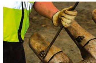
**Passaggio 3:** inserire il palanchino nella seconda scanalatura e premerlo nuovamente in direzione della sezione centrale della punta finché tutte e tre le scanalature non sono visibili. **Il meccanismo di blocco resterà attaccato alla punta.**
