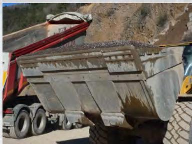
Sottolama Max-Temp carbide foratura Volvo
