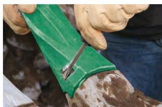
**Passaggio 8:** inserire il palanchino nella sezione inferiore del meccanismo di blocco e nella sezione laterale della punta. Spingere il palanchino in direzione della sezione centrale della punta finché il meccanismo di blocco non scatta in posizione. Un clic distinto indica che il blocco è scattato correttamente.
