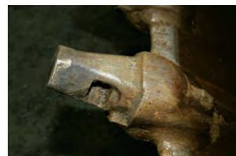
**Passaggio 6:** pulire il nasello da particelle e sporco. Dopo la pulizia, ispezionarlo per verificare che non sia eccessivamente usurato o danneggiato. Se necessario, ripararlo utilizzando la saldatrice o sostituire l'adattatore per assicurare prestazioni ottimali.
